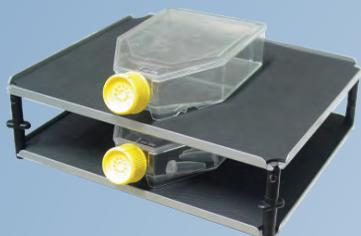
**Дополнительные уровни для платформы качающего шейкера S4:** Позволяет нарастить дополнительные платформы, увеличивая полезную площадь работы прибора.
