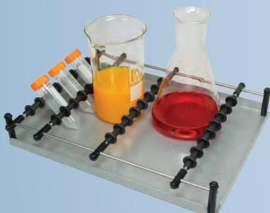
**Роликовые зажимы:** Универсальное средство для фиксации всевозможных ёмкостей. Обеспечивает максимально надёжную фиксацию даже самой неустойчивой лабораторной посуды.
