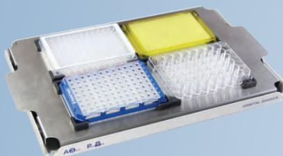
**Адаптер для микропланшет:** В зависимости от модели шейкера, позволяет надёжно зафиксировать от четырёх до восьми иммунологических 96 луночных микропланшет .
